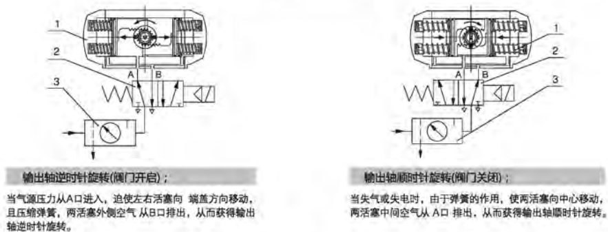
(b) 单作用弹簧复位工作原理俯视图
